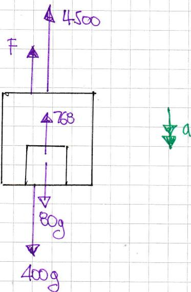
LOOKING AT THE FORCES ON THE BOX WHICH IS ACCELERATING DOWN
