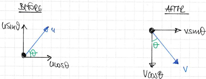
NO MOMENTUM EXCHANGE IN A DIRECTION PARALLEL TO THE WALL
